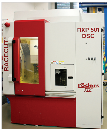
Během semináře bylo obrábění tvrdokovu demonstrováno na stroji RXP501DSC. (Foto: Klaus Vollrath)
