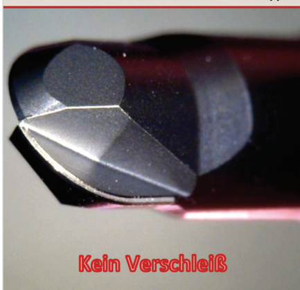
Frézy UDC po čtyřhodinovém používání při hrubování – bez opotřebení (Foto: Six Sigma Tools)
