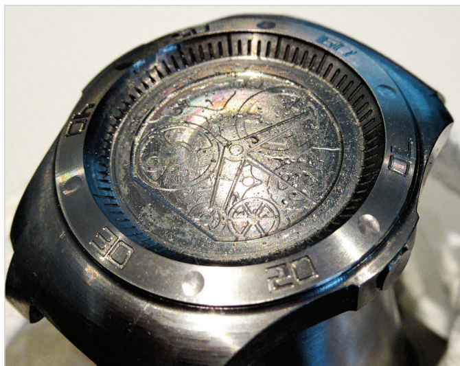
Pouzdro hodinek, vyfrézované z masivního bloku tvrdokovu (Foto: Klaus Vollrath)
