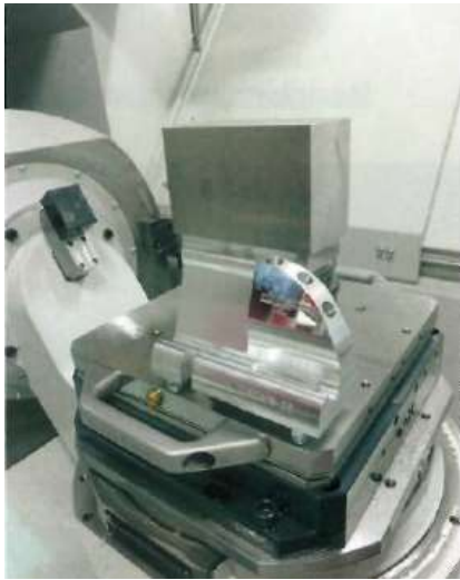
Z hliníkového bloku materiálu se stane držák na mobil s vysokým leskem: Røders vyfrézoval na veletrhu Formnext ve Frankfurt na stroji RXP 601 DSH za pouhých 30 minut krásný prototyp.
