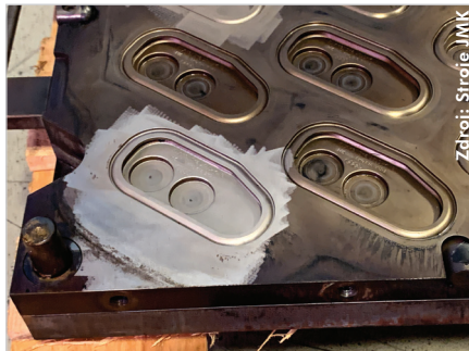
Perfektně očištěný povrch je důležitým předpokladem pro trvalé spojení.
