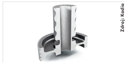
Obr. 3. Kolo planetové převodovky elektromobilu s průchozím otvorem pro honování. Takové součásti vykazují z důvodu nerovnoměrného rozdělení materiálu velmi často různé elastické deformace během opracování.
