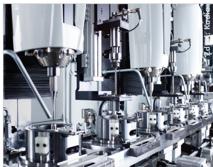
Obr. 1. Vnitřní uspořádání vysoce výkonného stroje v lince. Po každé honovací stanici následuje měřicí stanice. Pomocí zjištěných výsledků opracování je možné držet kvalitu opracování pomocí regulační smyčky v ideální oblasti.
