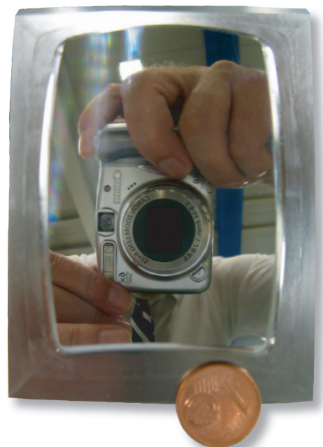
Vložka pro výrobu displejů mobilů opracovaná do zrcadlově lesklého povrchu R_a \sim 0,01\ \mu\text{m} (foto: Klaus Vollrath)
